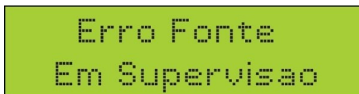
Figura 7. 4: Mensagem de fonte com defeito ou falta de energia elétrica.
