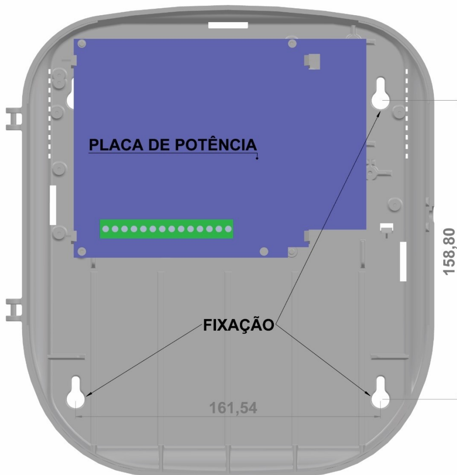
Figura 5. 2: Locais destinados para fixação da central.
